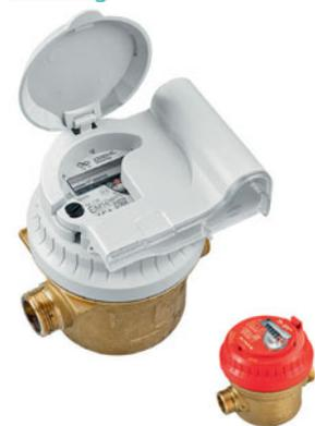
► Compteur d'eau volumétrique à piston oscillant - Compact - Corps en laiton ► Conforme Individualisation des Frais de Logement ► Approuvé MID toutes positions H ou V - ACS - Autres entraxes sur demande ► Équipé d'un module radio compact IZAR G4 OMS 868 MHz (version Mbus possible) ► Durée de vie de la pile jusqu'à 15 ans - IP68 - T° max. : 50°C froid et 90°C chaud
