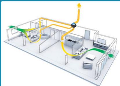
La **version de base auto-réglable** fonctionne à débit d'air constant et ne tient pas compte du taux d'humidité réel dans le logement.
