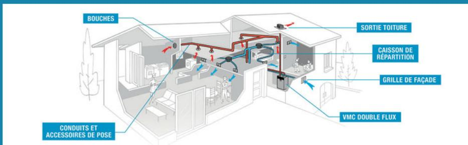
**En hiver**, contrairement à la version simple flux qui introduit de l'air extérieur froid, la double flux récupère les calories de l'air extrait pour le transmettre à l'air entrant qui aura été préalablement filtré.
